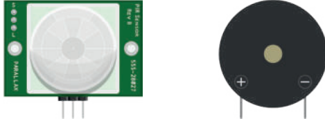
شكل 5.22: مُستشعر الحركة و طَنان الكهربائي
