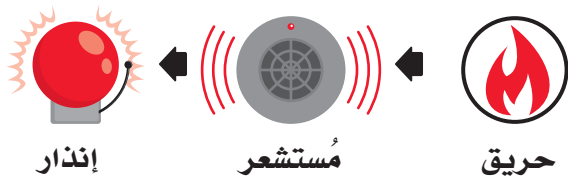
شكل 5.2: نظام إنذار الحريق
