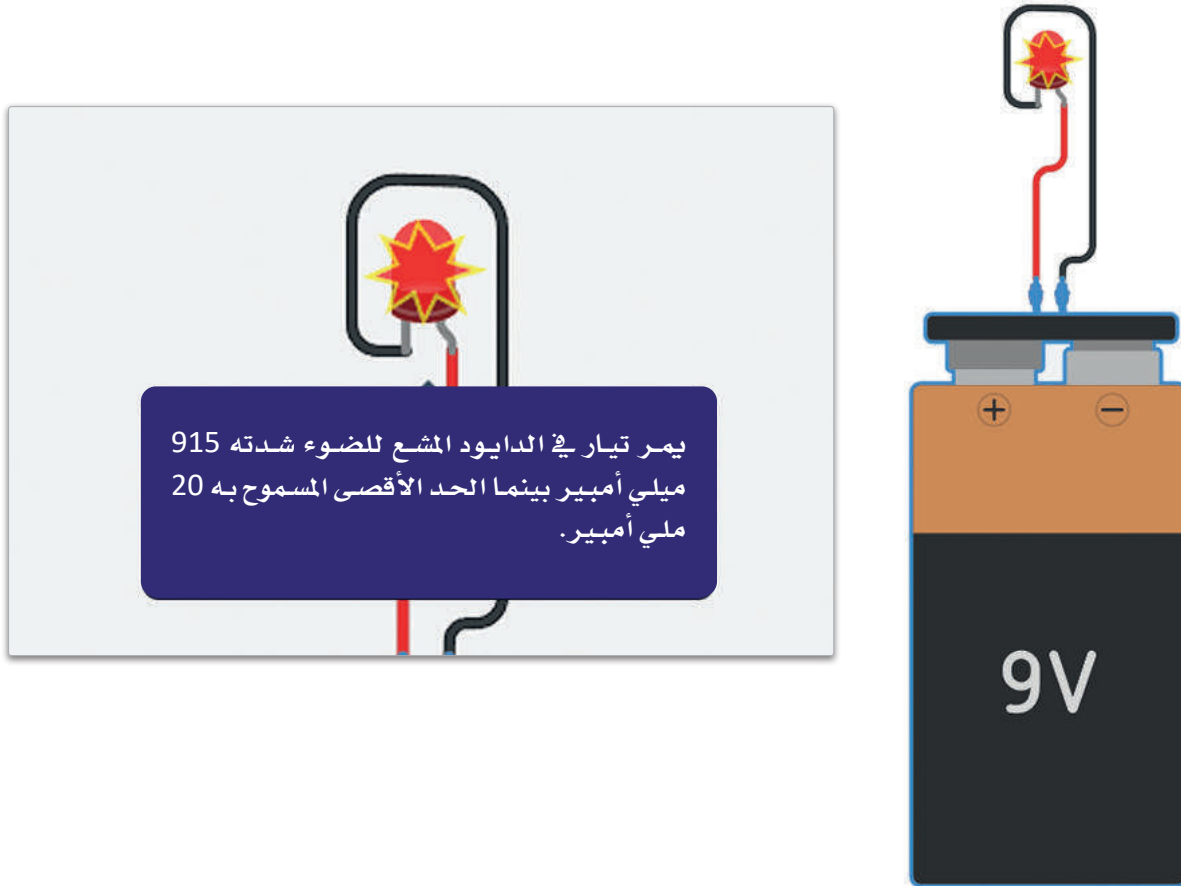
شكل 4.23: محاكاة مع وجود مشكلة في التيار في الدائرة
